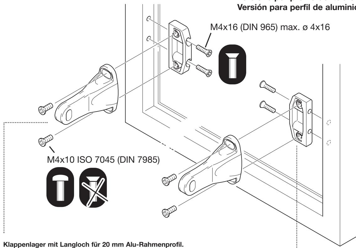
Klappenlager mit Langloch für 20 mm Alu-Rahmenprofil.
