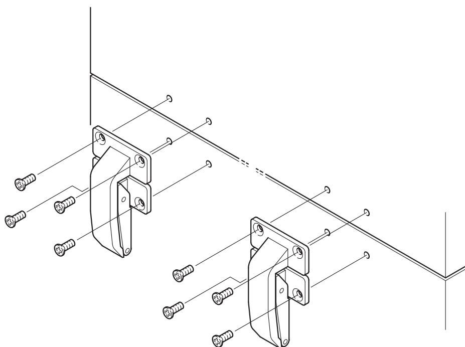
Klappenlager an unteren Schrankdeckel anschrauben.
