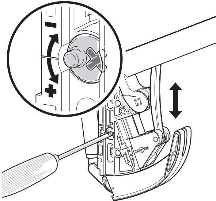
Die Einstellung des **Mittenanzuges** für die Schrankdeckel erfolgt über die Exenterschraube.(Siehe Scala)
