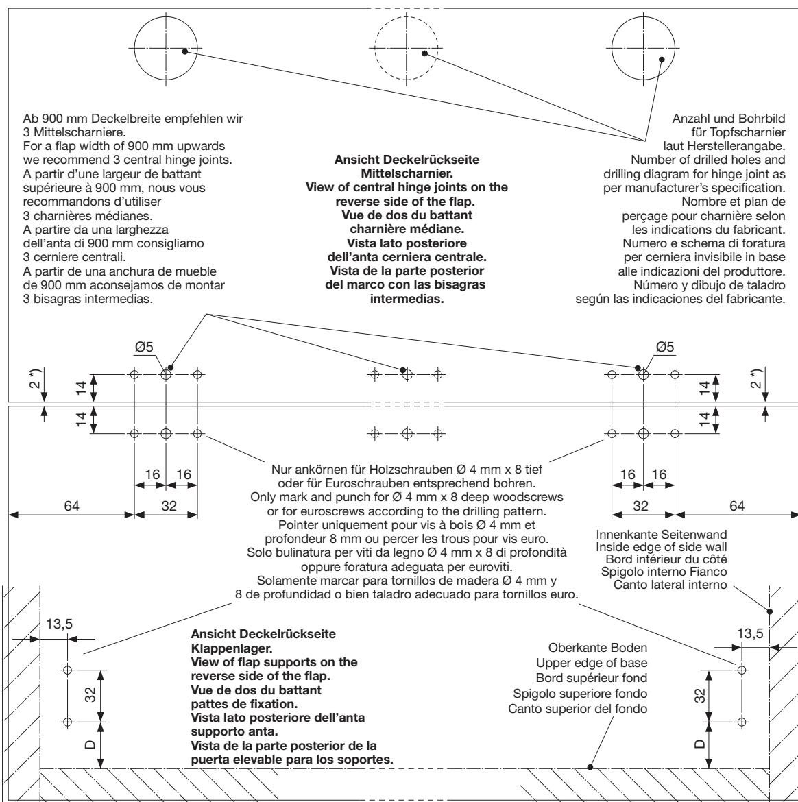
\*) = bei verstellbaren Mittelscharnieren 2-4 mm
