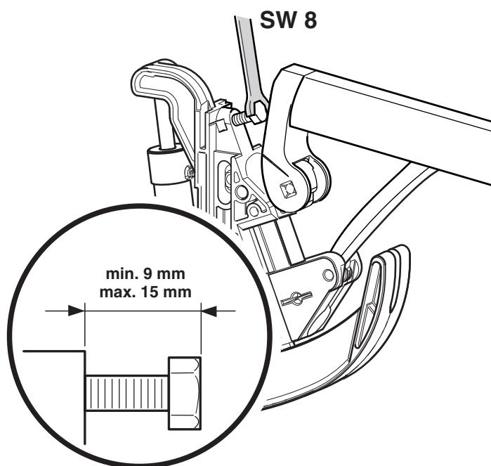
Die Verstellung des werksseitig voreingestellten **Endanschlages (ca. 12 mm)** erfolgt über die Anschlagschraube. Hierzu den Hebelarm / Schrankdeckel etwas nach unten ziehen.
