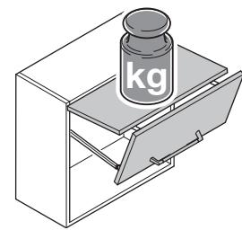
Die **Krafteinstellung** für das Schrankdeckelgewicht erfolgt über die Imbusschraube. (Siehe Scala) Hierzu Hebelarm/Schrankdeckel nach unten ziehen und nachfolgend einstellen.
