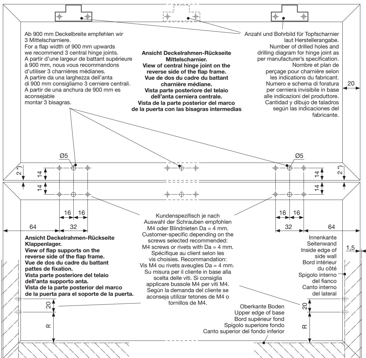
\*') = bei verstellbaren Mittelscharnieren 2-4 mm
