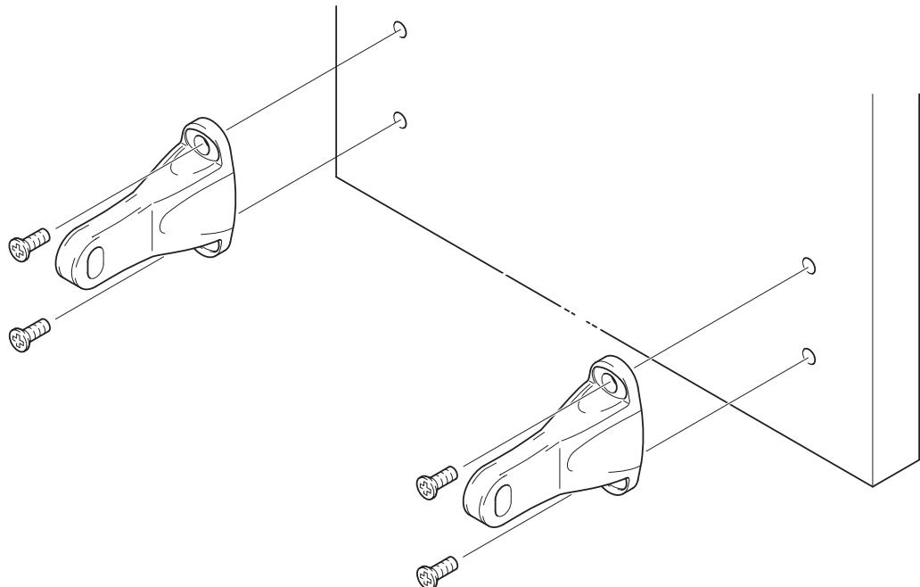
**Klappenlager für Holz-, Span- und MDF-Platte oder breite Rahmen ab 40 mm Breite.**
